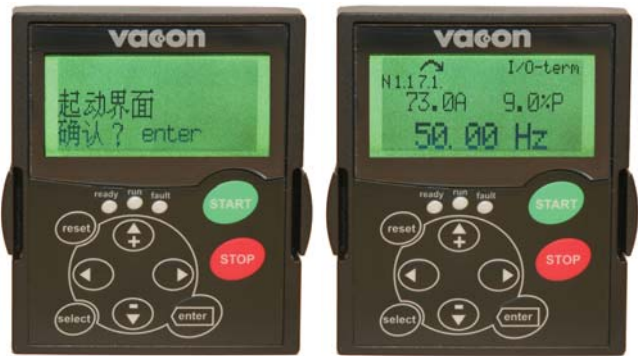
可以用面板同时监控最多3个参数(多参数监控特性)
